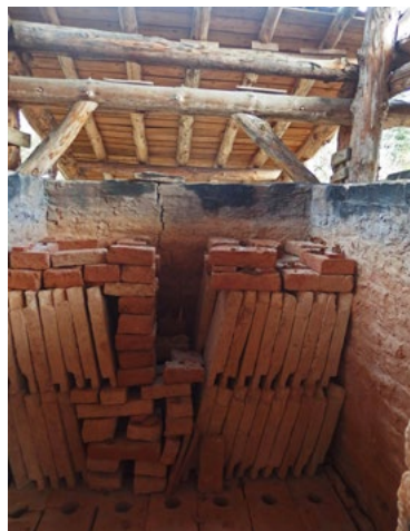
Le four tuilier expérimental de La Lie : défournement des briques et tuiles de type gallo-romain, novembre 2025
